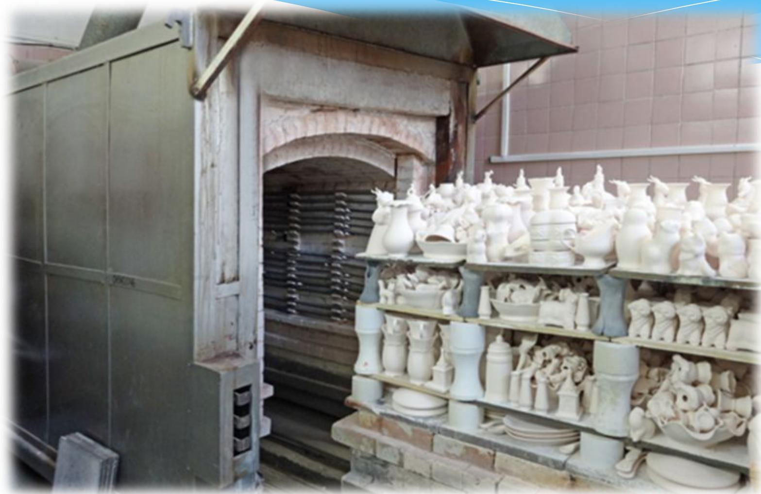
После предварительного обжига изделия проходят «фуксиновый контроль»: полуфабрикаты опускают в розовый нестойкий раствор фуксина, пропадающий под воздействием света. Этот технологический процесс даёт возможность проверить качество керамических изделий, делает заметными мелкие трещинки и сколы.
