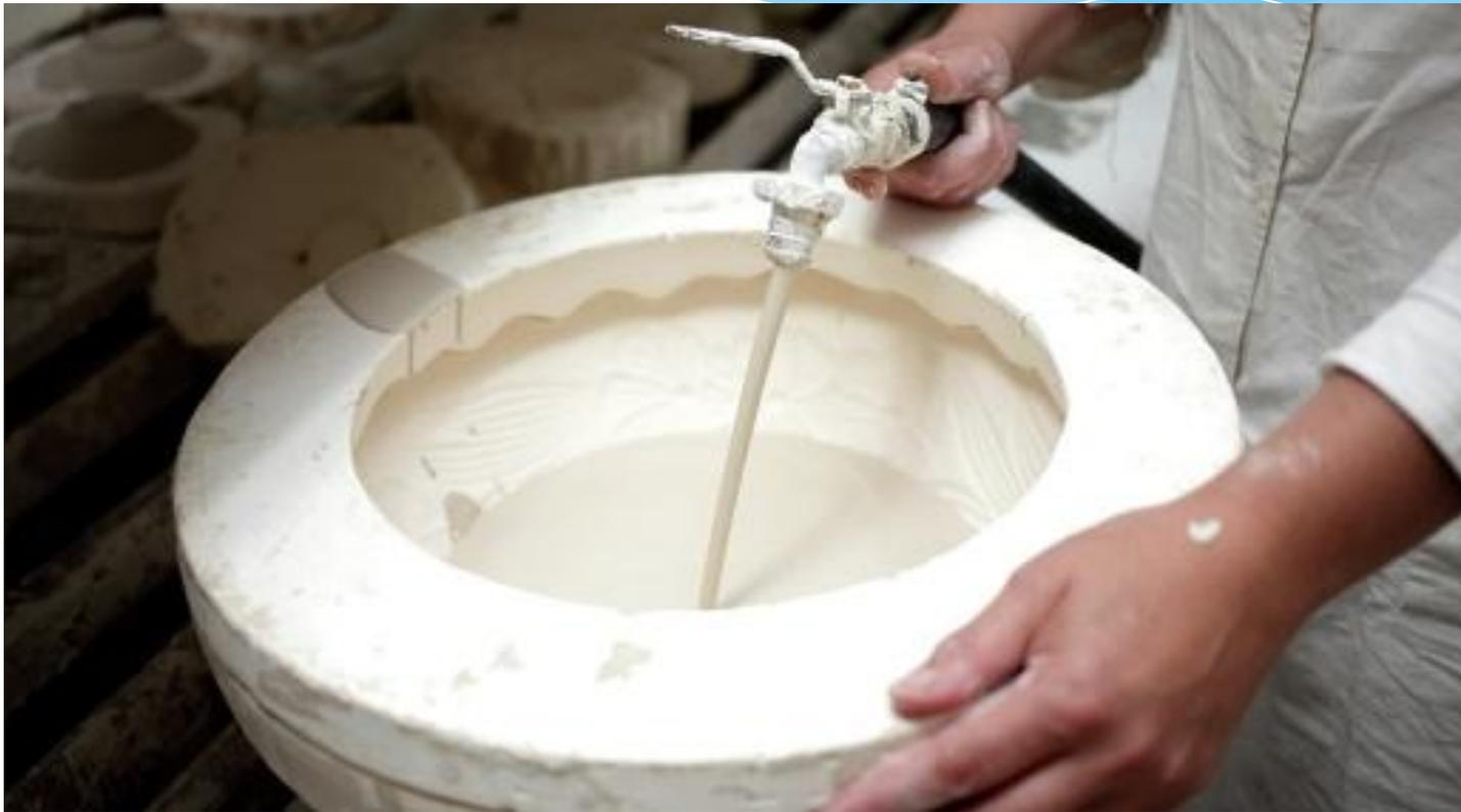
Пористый гипс вытягивает и впитывает влагу, шликер постепенно затвердевает, приобретая очертания формы. Далее форму раскрывают и достают полуфабрикат, вручную подправляют и заглаживают «швы».
