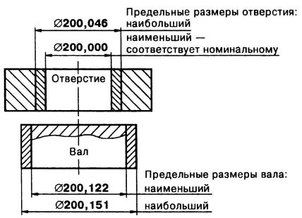
Натяг — разность между размерами вала и отверстия до сборки
