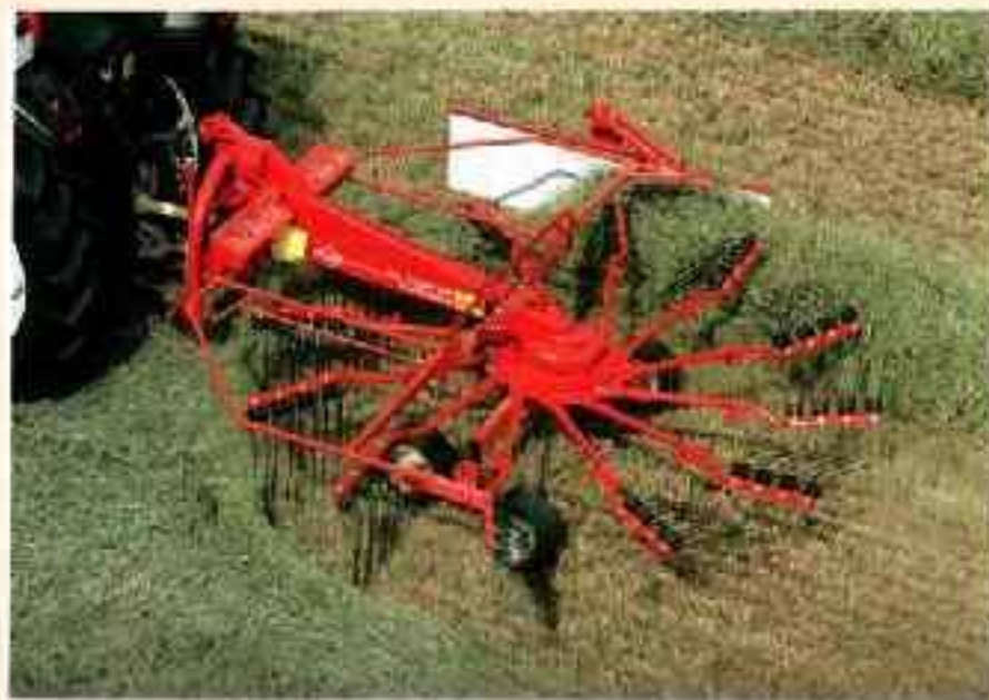
Рис. 3. Стребание в валки навесным валкообразователем GA
