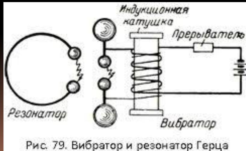
Рис. 79. Вибратор и резонатор Герца
