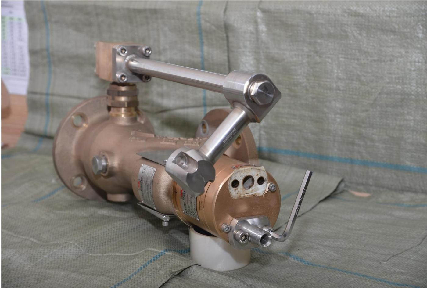
8. Шестигранным ключом открутить четыре винта крышки подшипника.
