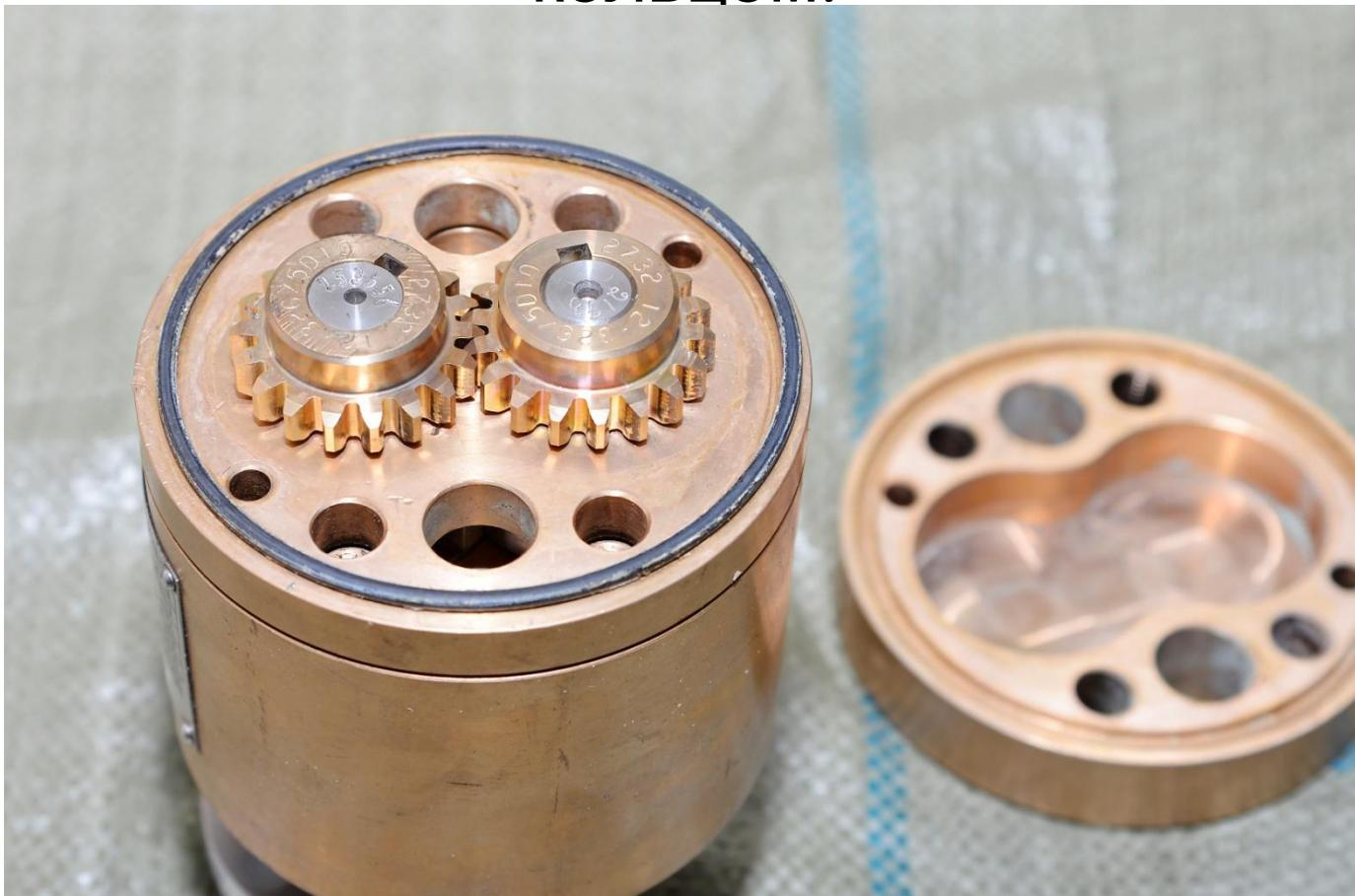
16. Запомнить по меткам расположение шестерен относительно друг друга. Если нет меток – пометить! Снять шестерни и шпонки с валов.
