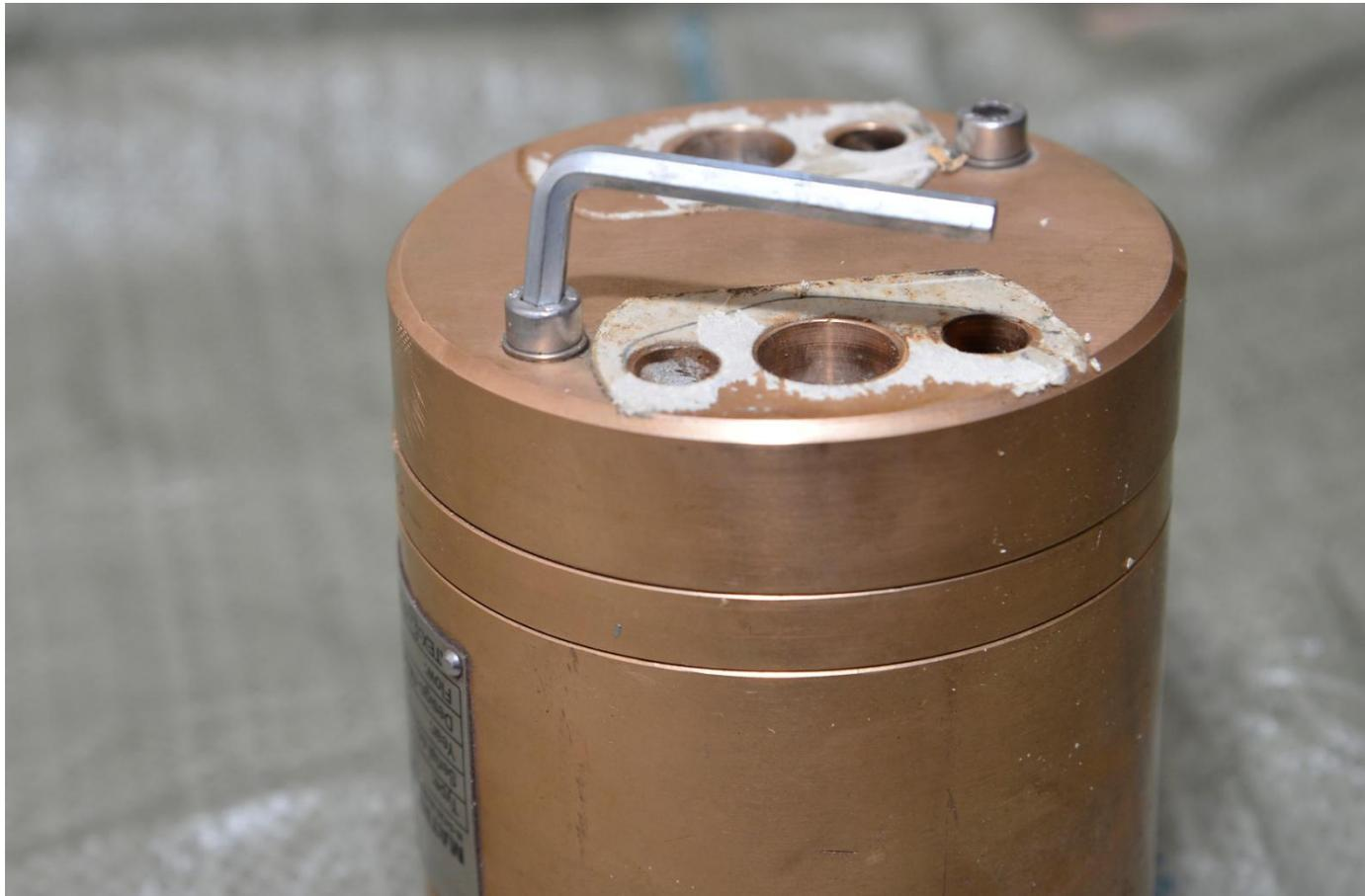
15. Пометив расположение задней крышки корпуса относительно основного корпуса, снять заднюю крышку с уплотнительным КОЛЬЦОМ.
