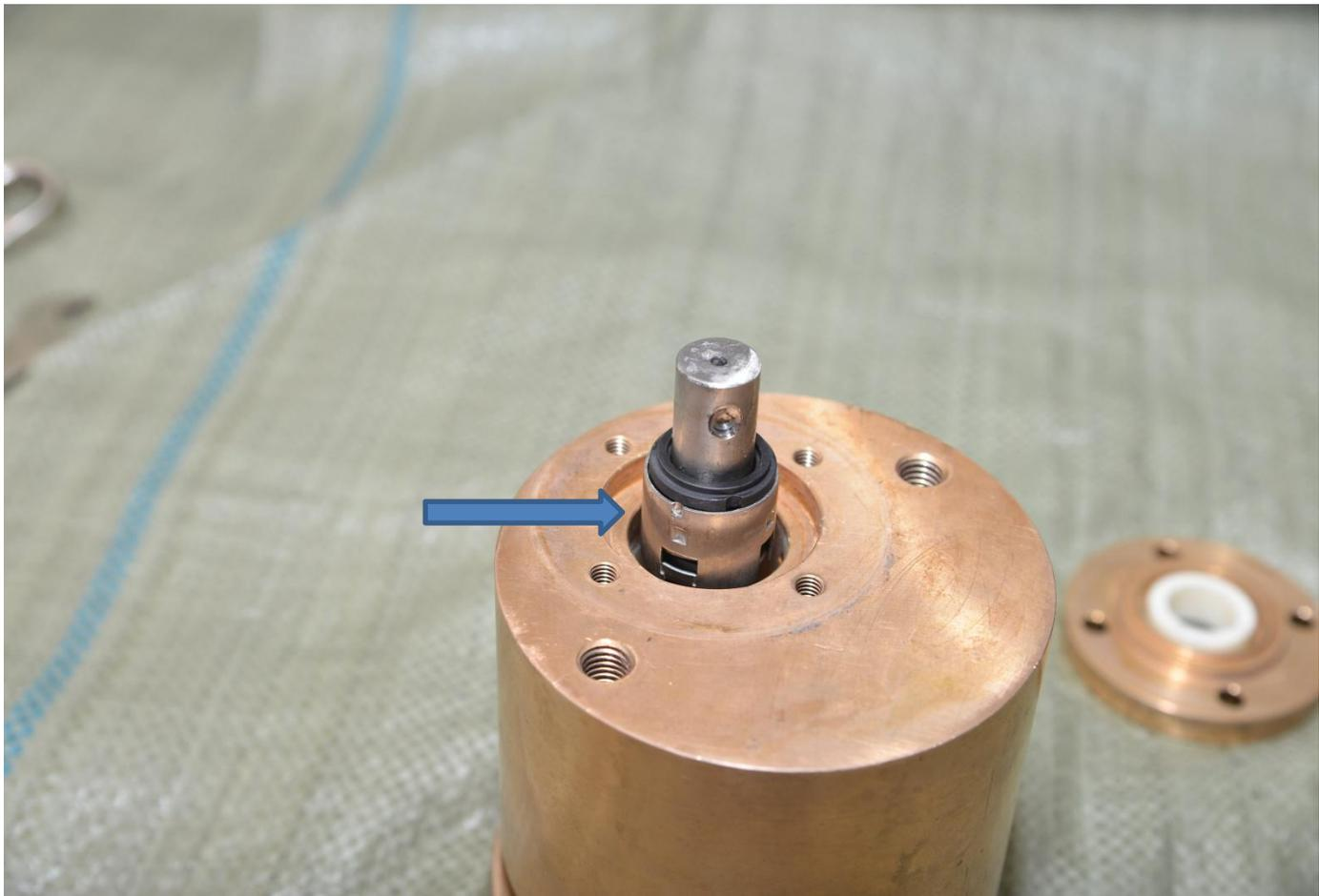
12. Снять пинцетом упорную шайбу с первичного вала.
