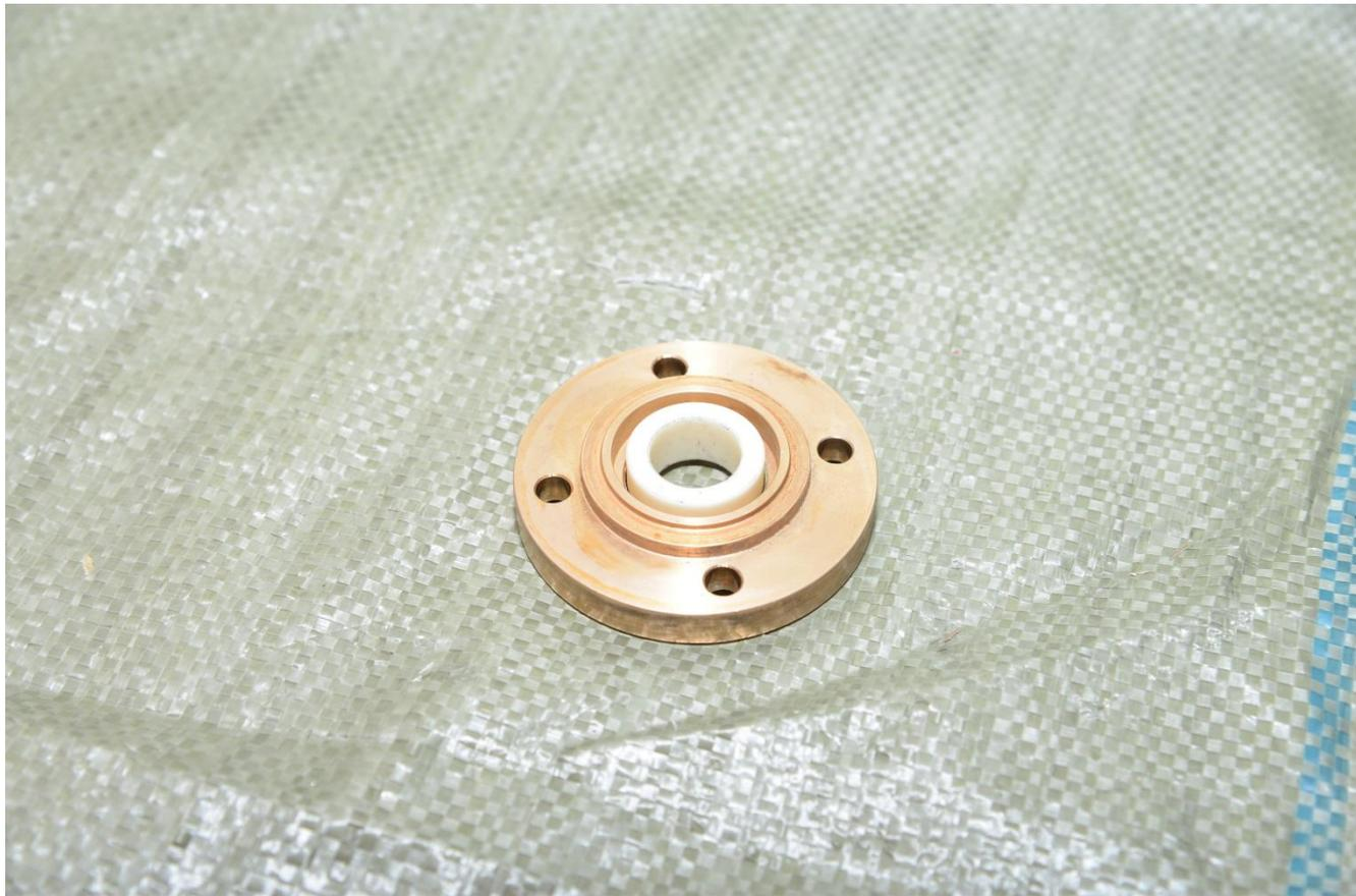
10. Извлечь подшипник, наружный сальник и уплотнительное кольцо из крышки подшипника.
