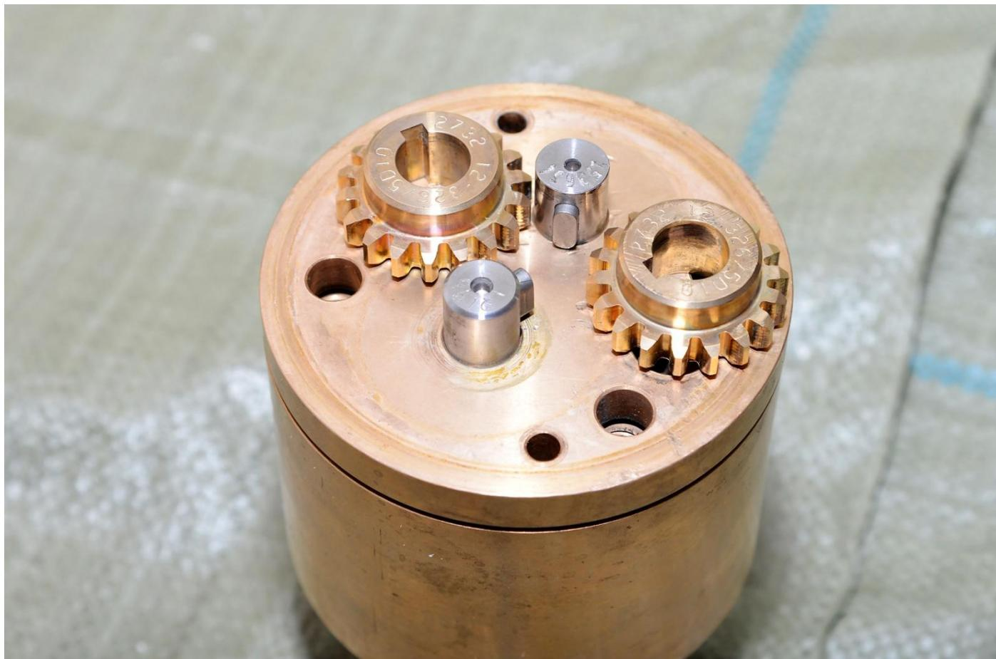
17. Пометив положение относительно корпуса, снять заднюю крышку насоса и уплотнительное кольцо.
