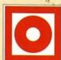
Кнопка включения установок (систем) пожарной автоматики
