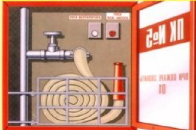
ВНУТРЕННИЙ ПОЖАРНЫЙ КРАН
