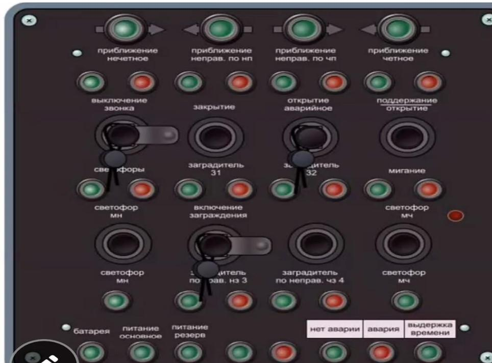
Лампочки (светодиоды) УЗ1, УЗ2, УЗ3, УЗ4. Лампочки (светодиоды) зеленого свечения сигнализируют о нижнем положении крышек УЗ, а лампочки (светодиоды) красного свечения справа сигнализируют о поднятом положении крышек УЗ.
