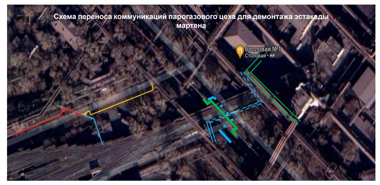
Теплотрасса на столовую №1 Ду-76 мм (труба 76\*6-190 м в 2 трубы, 16 отводов, 2 задвижки Ру-25, Ду-80 мм, покраска+изопяция)
