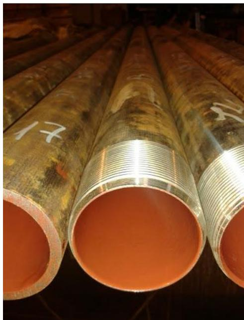
Насосно-компрессорные трубы являются каналом для проведения СКО, а также служат для спуска оборудования в скважину
