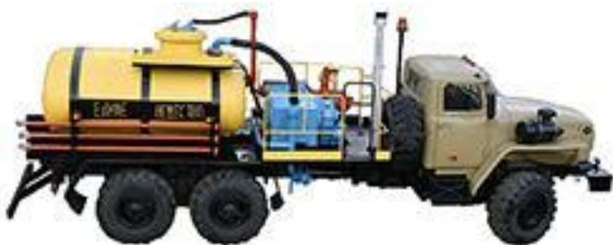
Насосные установки типа УНЦ1-160 предназначены для транспортировки и нагнетания в скважину смеси кислот при солянокислотной обработке призабойной зоны
