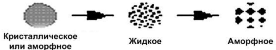
Короткий лазерный импульс высокой мощности расплавляет записывающий материал (**температура нагрева превышает температуру плавления материала**,  $T > T_{\text{плавл}}$ ). Затем следует охлаждение ниже температуры кристаллизации ( $T_{\text{крист}}$ ).
