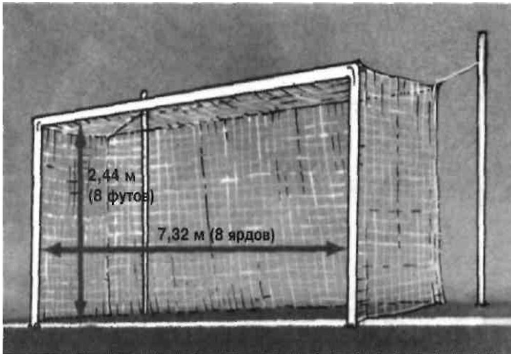
Расстояние между стойками — 7,32 м, а расстояние от нижнего контура перекладины до поверхности земли — 2,44 м. Ширина и высота сечения обеих стоек и перекладины одинаковы и не превышают 12 см. Ширина линии ворот равна ширине стоек и перекладины. К воротам и грунту за воротами могут прикрепляться сетки, которые должны быть надежно закреплены и расположены так, чтобы не мешать вратарю. Стойки и перекладины ворот должны быть белого цвета
