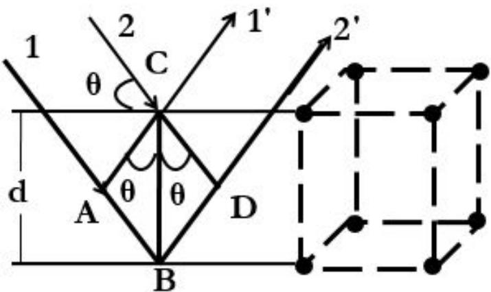
Разность хода лучей 1 и 2 при отражении от кристаллографических плоскостей может быть выражена:
