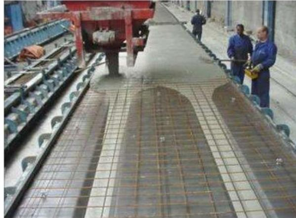
Самоуплотняющийся бетон (СУБ) – многокомпонентный бетон, который в свежеприготовленном состоянии обладает таким уровнем текучести и подвижности, что бетонная смесь способна заполнять опалубку в процессе укладки только за счет собственного веса и достигать требуемой степени уплотнения без применения внешнего уплотняющего воздействия
