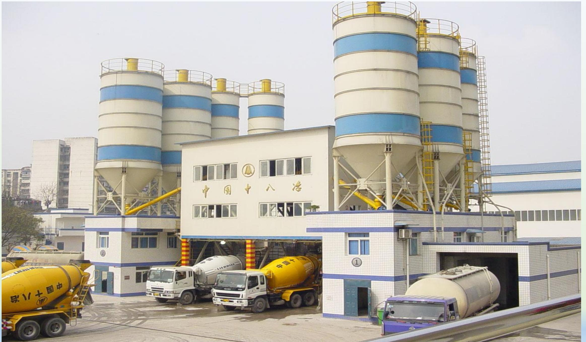
Главное требование к бетоносмесительному оборудованию — обеспечение качественного приготовления бетонной смеси. Чем быстрее, но при этом качественно, перемешана бетонная смесь, тем выше ценится такое оборудование. Совокупность скорости подачи инертных материалов, точности их дозировки и определения водоцементной составляющей, для проектной марки бетона, определяют выбор бетоносмесительного оборудования.
