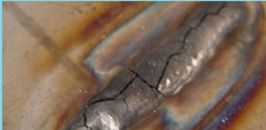
Наименование дефекта: **Поперечная трещина сварного соединения**
