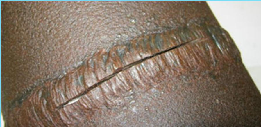
Наименование дефекта: **Продольная трещина** сварного соединения
