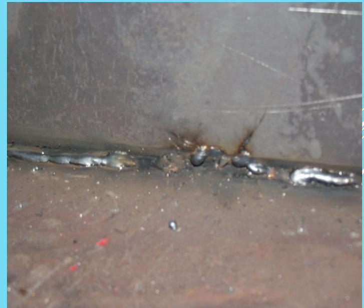
**Кратер** - усадочная раковина в конце валика сварного шва.
