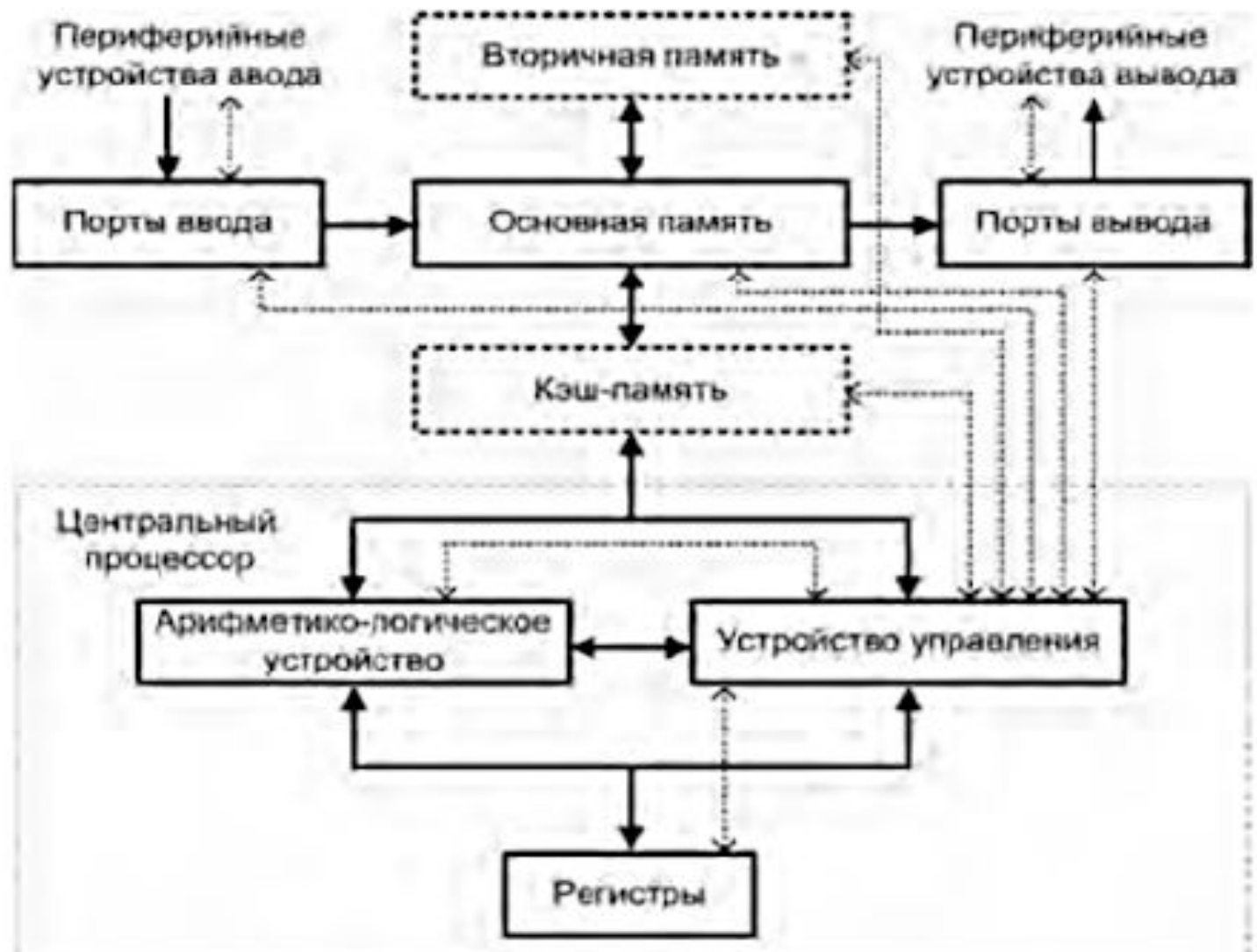
Структура фон-неймановской вычислительной машины
