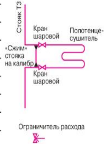
Узел подключения полотенцесушителя
