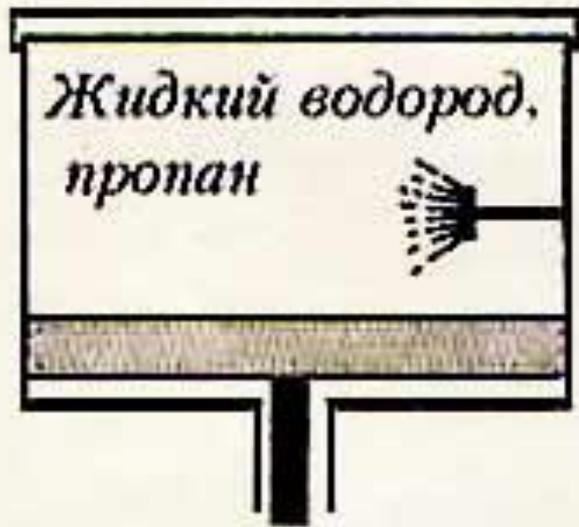
При резком понижении поршня жидкость, находящаяся под высоким давлением, переходит в **перегретое состояние**. При быстром движении частицы по следу образуются пузырьки пара, т. е. жидкость закипает, виден **трек**.
