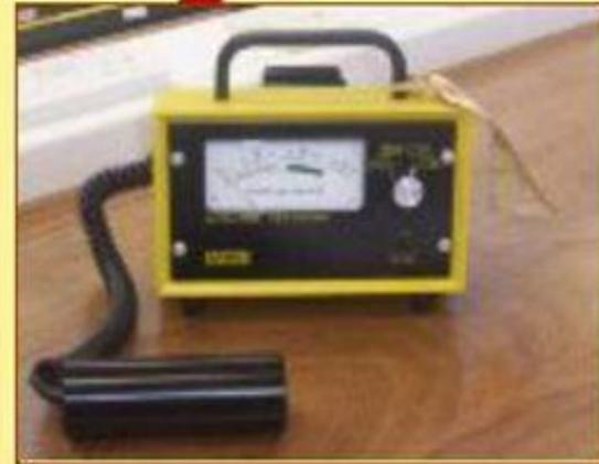
*В наполненной аргоном трубке пролетающая через газ частичка ионизирует его, Между катодом и анодом возникает электрический ток, на резисторе, на резисторе  $R$  образуется напряжение.*
