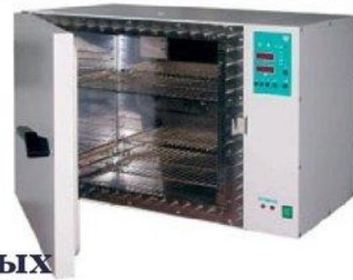
стерилизация осуществляется в специальных аппаратах - сухо-жаровых шкафах-стерилизаторах. Стерилизация в сухожаровом шкафу происходит при помощи циркуляции внутри него горячего воздуха.
