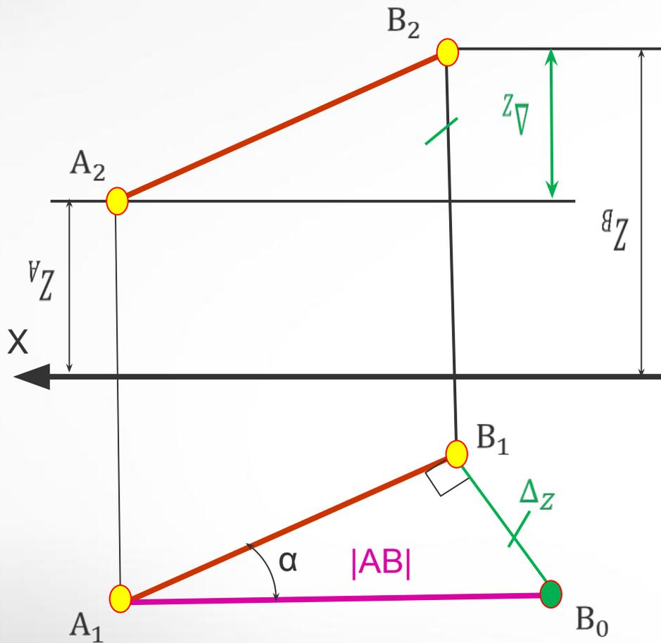
● **Натуральной величиной** отрезка является **гипотенуза** прямоугольного треугольника, у которого **одним** из **катетов** равен **проекция отрезка на плоскости проекций**, **вторым катетом** - **разность расстояний от концов отрезка до данной плоскости проекций**. **Угол наклона** отрезка к той или иной плоскости проекций **равен углу между гипотенузой - Н.В. и катетом- проекцией** на эту плоскость проекций.
