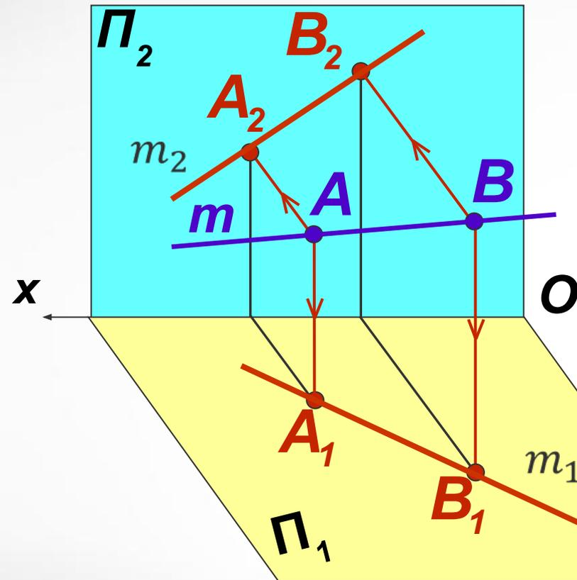
Положение прямой  $m$  в пространстве определяют две произвольные точки  $A$  и  $B$ , лежащие на этой прямой. Это наиболее удобный способ задания прямой. Прямая линия  $m$  считается заданной, если на комплексном чертеже построить проекции двух ее точек  $A$  и  $B$ .
