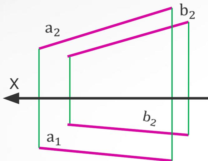
Если прямые в пространстве параллельны, то их одноименные проекции тоже параллельны.
