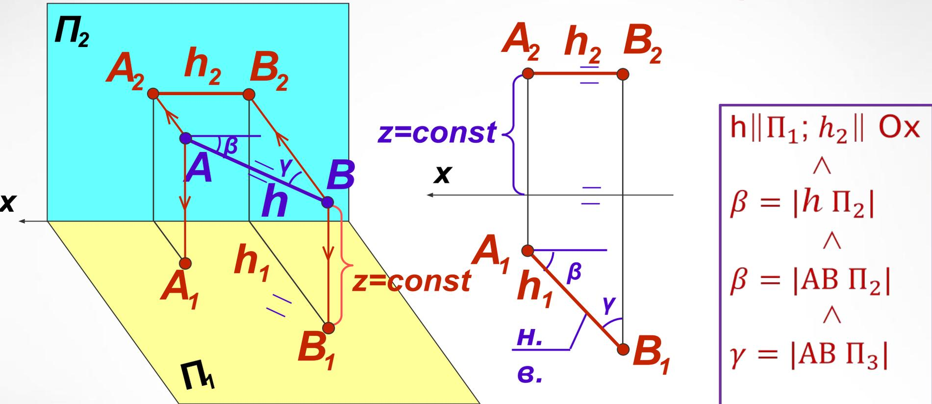
Все точки прямой  $AB$  равноудалены от горизонтальной плоскости проекций  $\Pi_1$  и имеют одинаковую аппликату  $z = const$ . Фронтальная проекция горизонтали  $A_2B_2$  параллельна оси  $x$ . Горизонтальная проекция горизонтали  $A_1B_1$ , углы  $\beta$  и  $\gamma$  изображаются в натуральную величину на  $\Pi_1$ .
