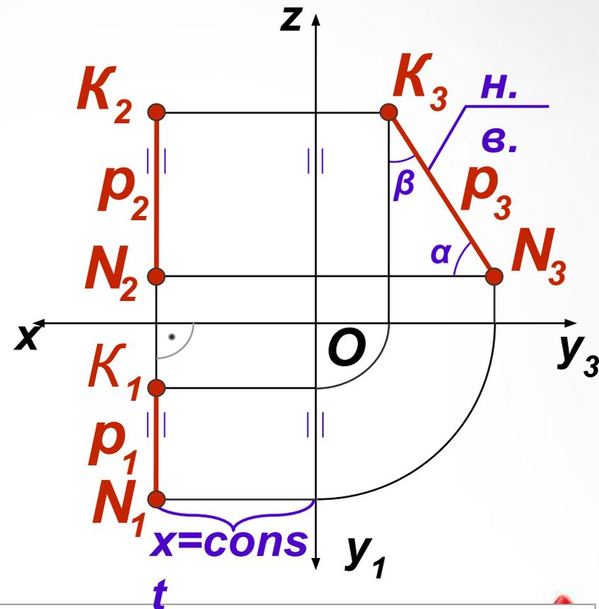
Все точки прямой  $KN$  равноудалены от профильной плоскости проекций  $\Pi_3$  и имеют одинаковую координату  $x$  ( $x = const$ ). Горизонтальная  $K_1N_1$  и фронтальная  $K_2N_2$  проекции прямой перпендикулярны оси  $x$ . Профильная проекция  $K_3N_3$ , углы  $\alpha$  и  $\beta$  имеют натуральную величину на  $\Pi_3$ .
