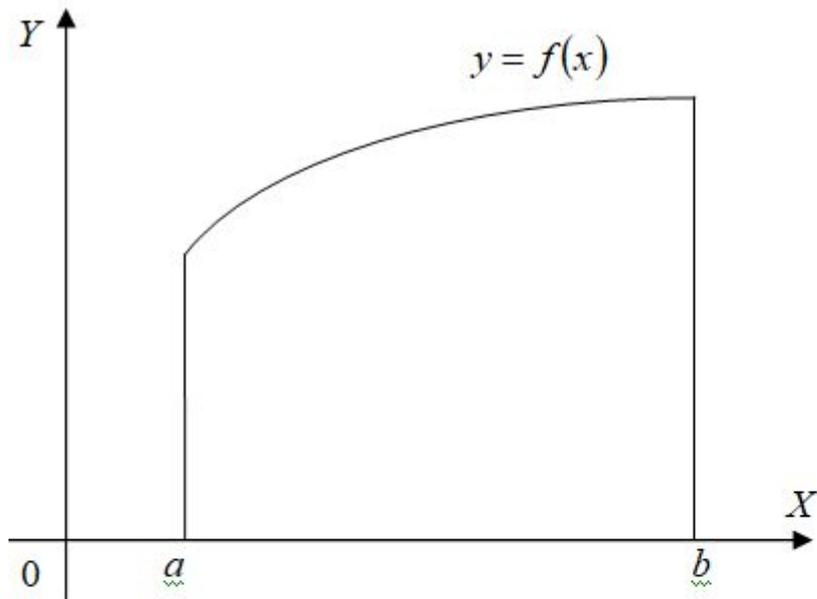
Если  $f(x) > 0$ , то интеграл  $\int_a^b f(x) dx$  численно равен площади криволинейной трапеции, ограниченной кривой  $y = f(x)$ , прямыми  $x = a$ ,  $x = b$  и осью  $Ox$ :
