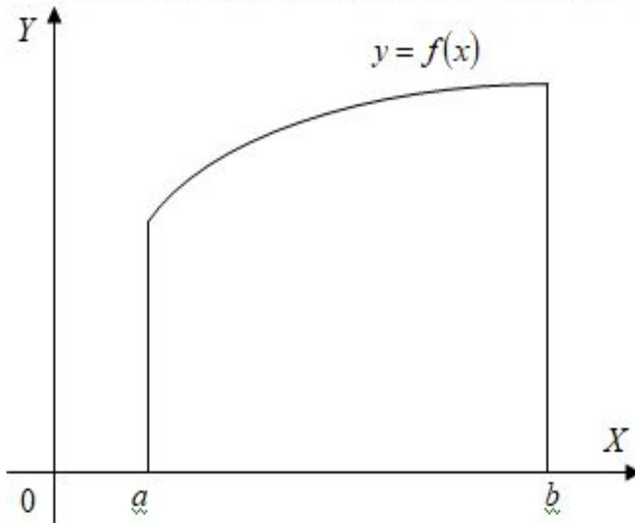
Площадь криволинейной трапеции, ограниченной непрерывной кривой  $y = f(x) (f(x) \geq 0)$ , двумя прямыми  $x = a$ ,  $x = b$  и отрезком  $[a; b]$  оси  $OX$  вычисляется по формуле:
