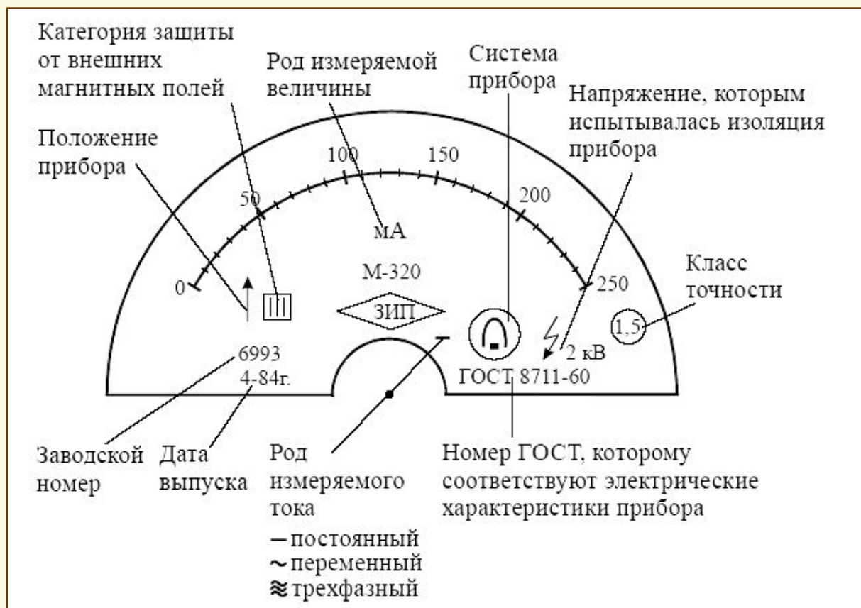
Рис. 1. Лицевая панель аналогового стрелочного прибора непосредственной оценки
