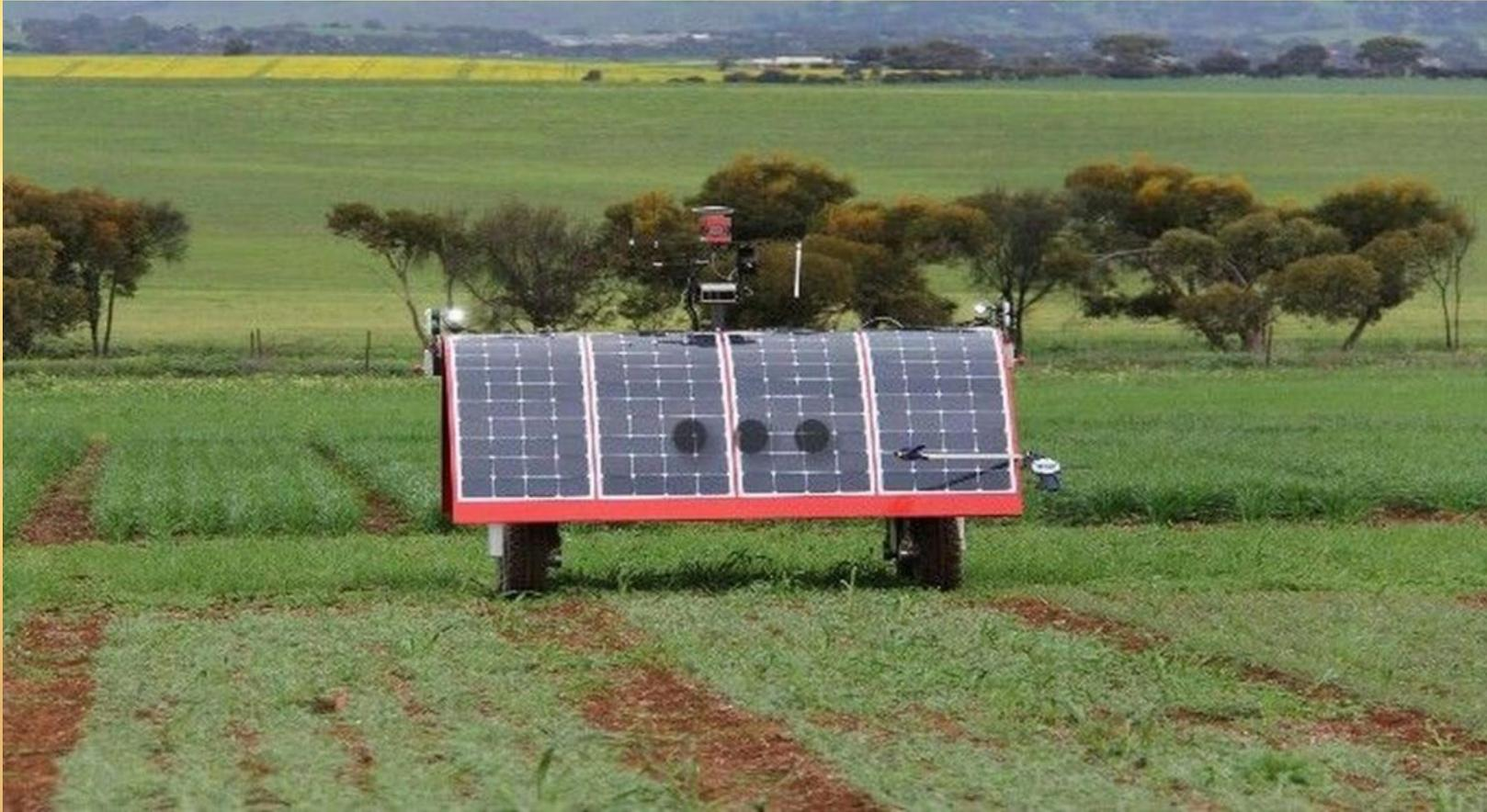
Усовершенствованные машины, такие как RoboCOP, удаляют сорняки без химической обработки. Они распознают сорняки и удаляют их с помощью тракторов мотыгами и лопатами. Тут применена технология компьютерного зрения, которая приносит огромную пользу в процессе выращивания урожая. Другие машины, разработанные с технологией компьютерного зрения, распознают растения которым необходимо удобрение или подкормка и дозированно добавляет их в почву.
