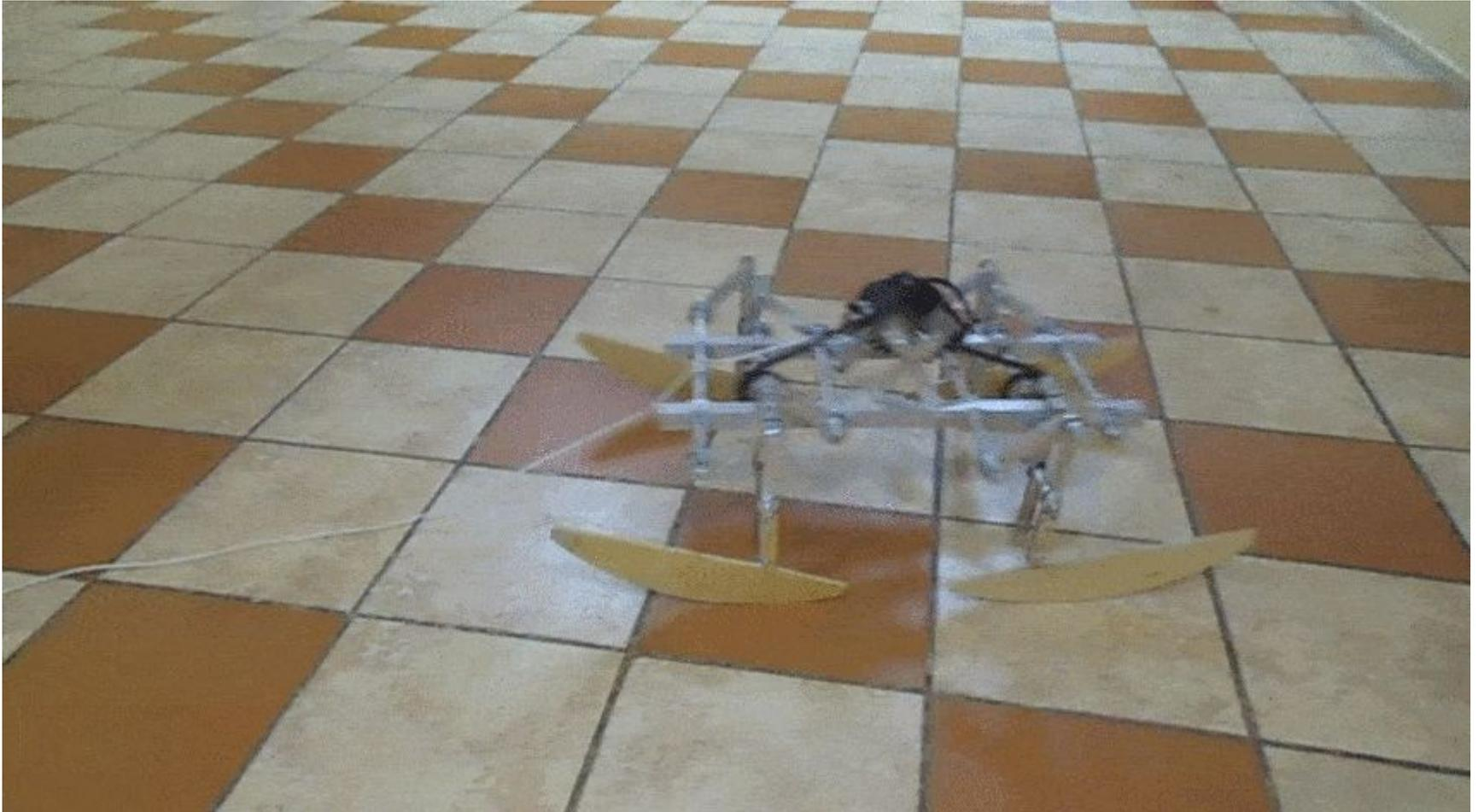
**Цель автономного испытания – проверить плавность работы кулачковой опоры**
