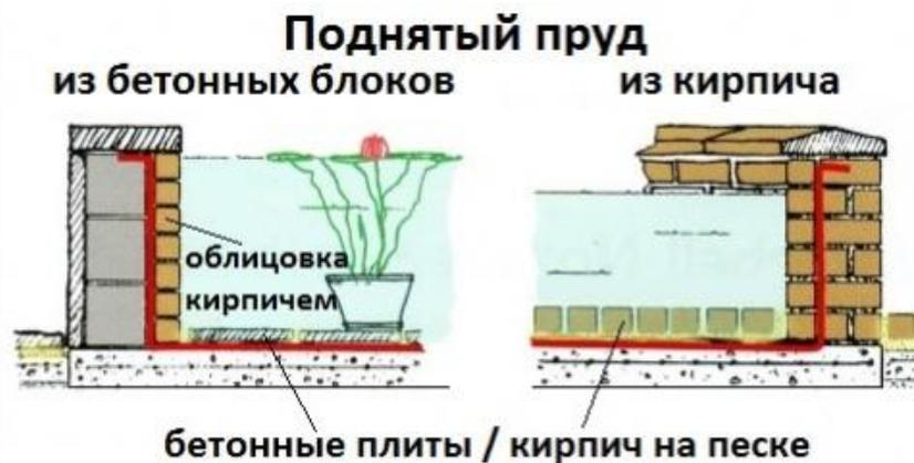
Пример гидроизоляции водоема или резервуара с бетонным основанием
