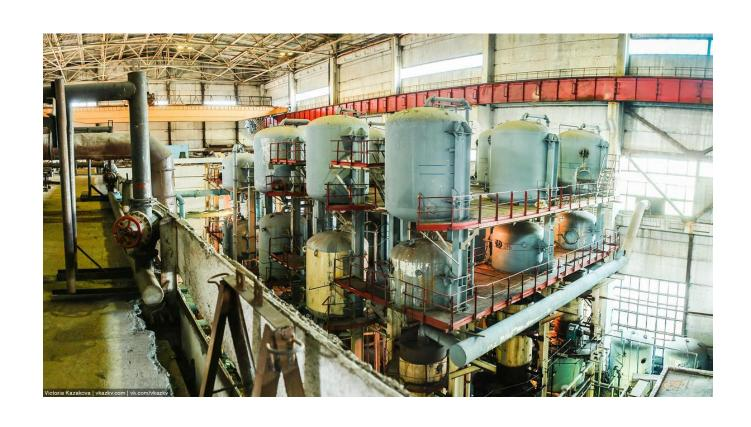
В практике проведения химических реакций в реакторе идеального смешения вследствие немедленного вывода части исходных компонентов из реактора всегда присутствует неполнота завершения процесса. Поэтому прибегают к каскадам реакторов идеального смешения.
