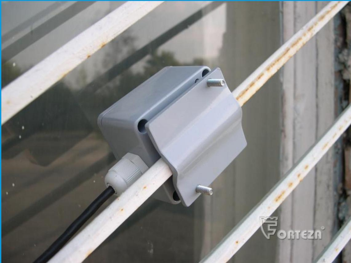
Вибрационные средства обнаружения — принцип действия основан на улавливании чувствительным элементом (ЧЭ) колебаний ограждения и преобразования этих колебаний в электрический сигнал. ЧЭ представляет собой экранированный кабель, обладающий свойствами усиления и стабилизации трибоэффекта (возникновения электрического заряда при механическом воздействии на кабель).
