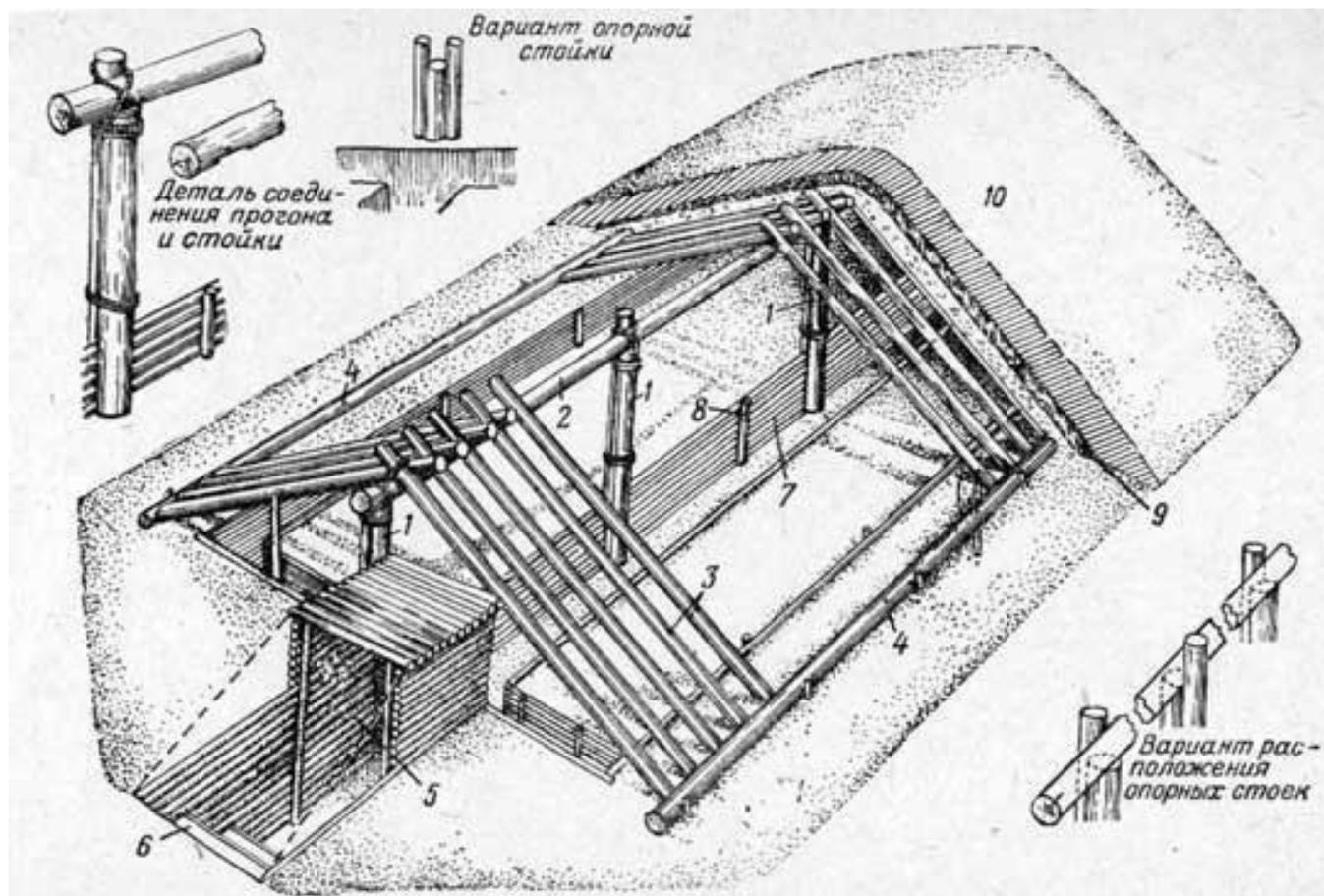
Рис. 19. Устройство двускатной землянки:
