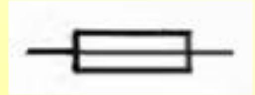
Чтобы не возникали недопустимые токи, в электрическую цепь включается **предохранитель**, который автоматически размыкает цепь, если ток превысил допустимое значение. Самый простой вид – плавкий предохранитель. Он применяется, например, в бытовой радиоаппаратуре. Главная часть - **проволочка из свинца**, толщина которой рассчитана на определенный ток. При коротком замыкании проволочка плавится и размыкает цепь.
