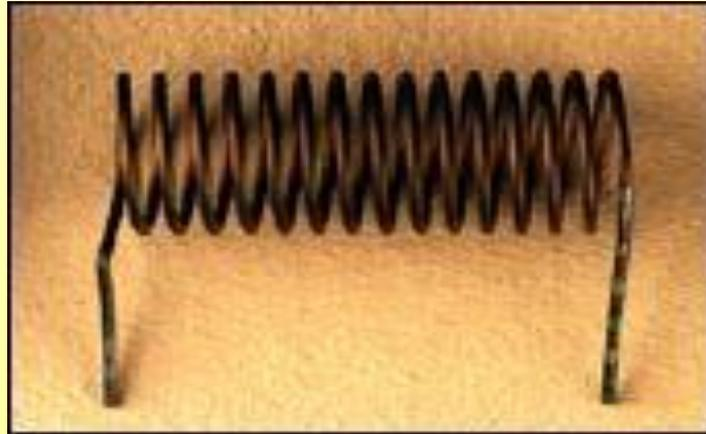
Нагревательный элемент представляет собой проводник с большим удельным сопротивлением и высокой температурой плавления.
