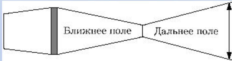
Место наибольшего сужения ультразвукового луча называется **зоной фокуса**, а расстояние между трансдьюсером и зоной фокуса — **фокусным расстоянием**. Существуют различные способы фокусировки ультразвукового луча. Наиболее простым способом фокусировки является акустическая линза
