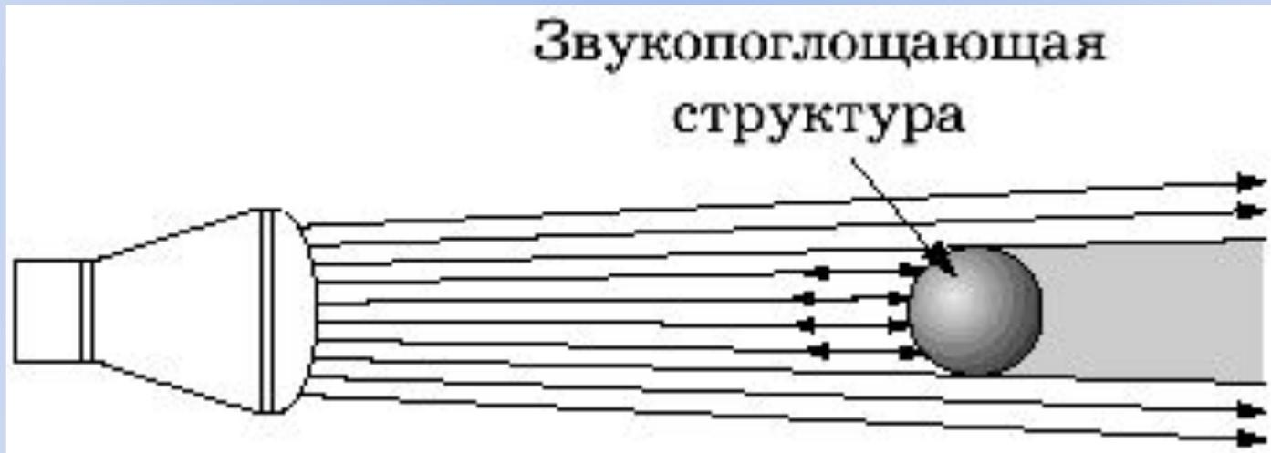
Артефакт **дистального псевдоусиления** сигнала возникает позади слабо поглощающих ультразвук структур (жидкостные, жидкостьсодержащие образования).
