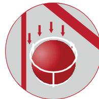
Для размещения устройства в автономном режиме необходимо установить крепление большим диаметром окружности вверх.
