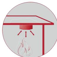
3. При контакте с огнём устройство самостоятельно активируется с оповещающим хлопком и мгновенно тушит очаг возгорания.
