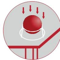
Для размещения в ручном режиме универсальное крепление используется как подставка, которая располагается большим диаметром окружности крепления вниз.
