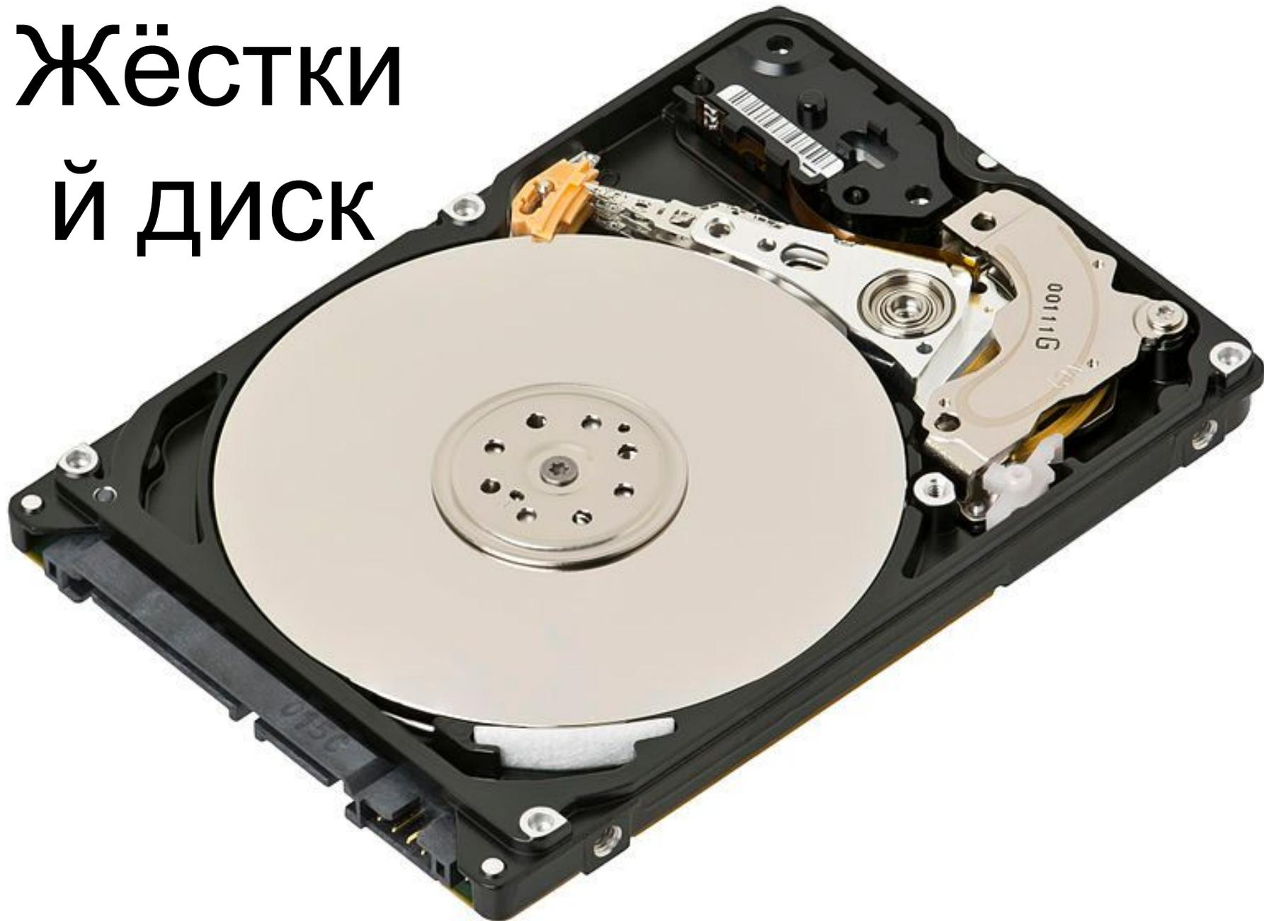
Накопитель на жёстких магнитных дисках или НЖМД (англ. hard (magnetic) disk drive, HDD, HMDD), жёсткий диск, в компьютерном сленге «винчестер» — запоминающее устройство (устройство хранения информации) произвольного доступа, основанное на принципе магнитной записи. Является основным накопителем данных в большинстве компьютеров.
