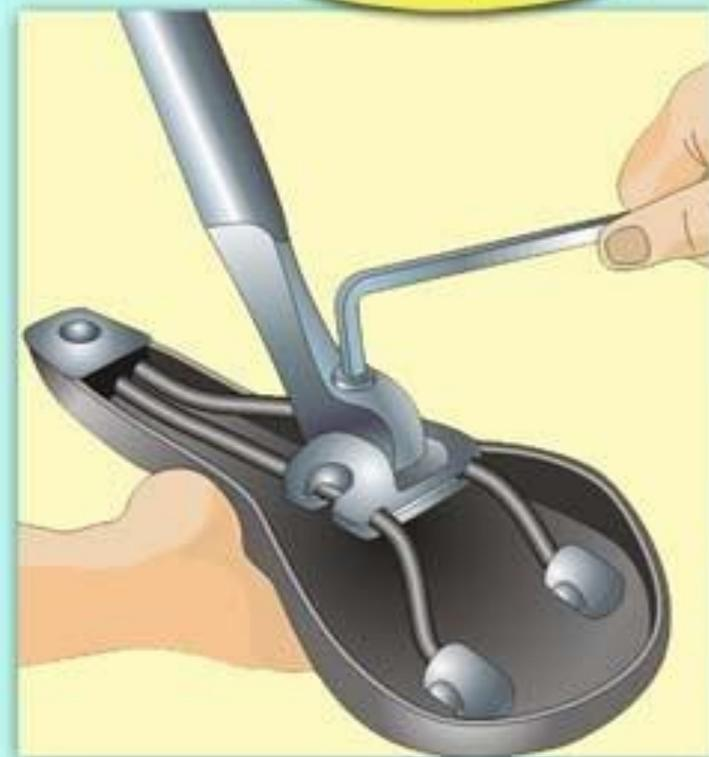
Проверьте, чтобы положение седла было удобным для езды, и чтобы при опускании педалей, ваши ноги были почти выпрямлены. Затем проверьте винт или винты зажима седла.
