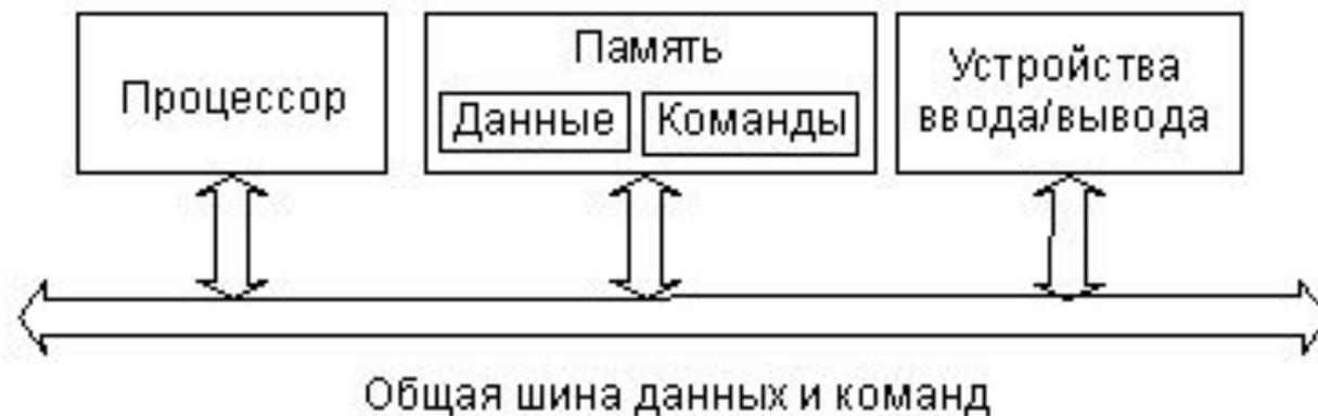
Рисунок 1 – Структурная схема ЭВМ согласно архитектуре фон Неймана
