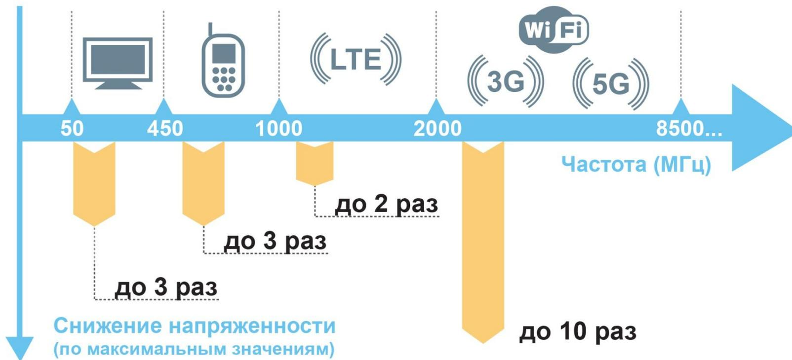
Ослабление поля на разных частотах регистрируется с использованием стенда измерения напряженности ЭМП (ОАО "Научно-исследовательский институт особо чистых материалов", протокол № 23 от 18 марта 2016 г.).
