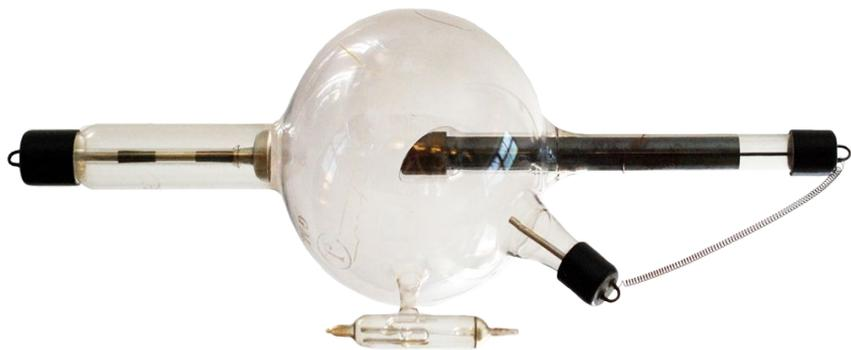
**Рентгеновская трубка** — это электровакуумный прибор, предназначенный для генерации рентгеновского излучения.
