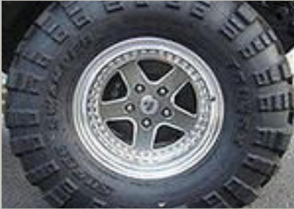
На современных автомобилях используются бескамерные шины. Воздух в них накачивается в пространство между покрышкой и колесным диском. Бескамерные шины более удобны и надежны в эксплуатации.
