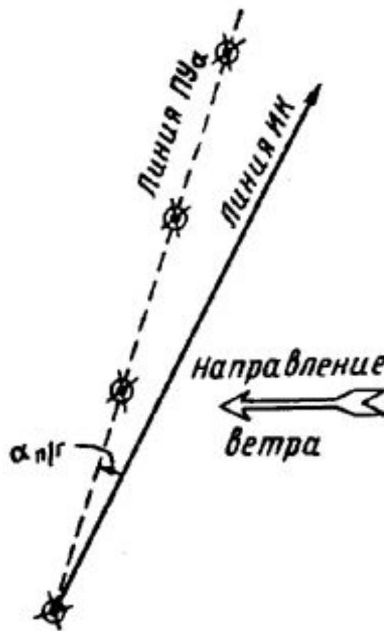
Рис. 34. Определение угла дрейфа
