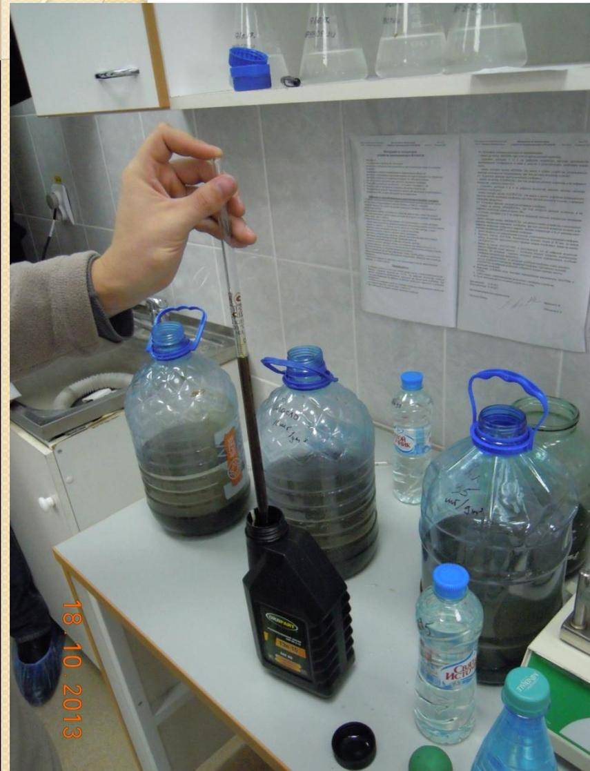
С помощью пипеток было произведено дозирование машинного масла и нефтепродуктов концентрацией 3мг/л. в соответствии с нанесённой на канистры маркировкой
