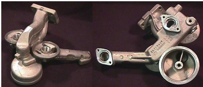
Литые заготовки корпуса форсунок
