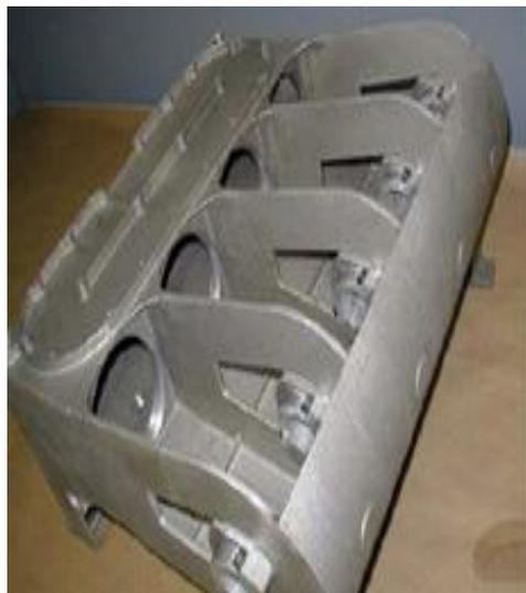
Литые заготовки корпусных деталей
