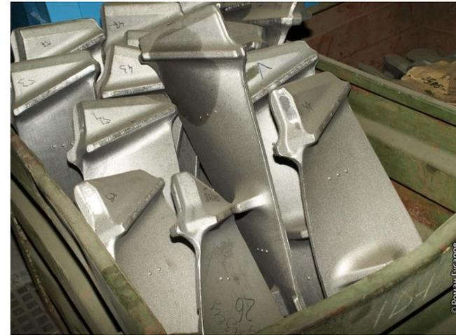
Заготовки титановых лопаток после изотермической штамповки и обычной штамповки
