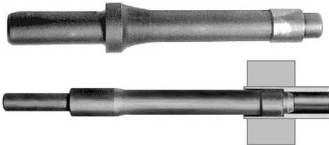
Рис.5.4. Оправка для удаления из трубных решеток труб после их обработки зенковками
