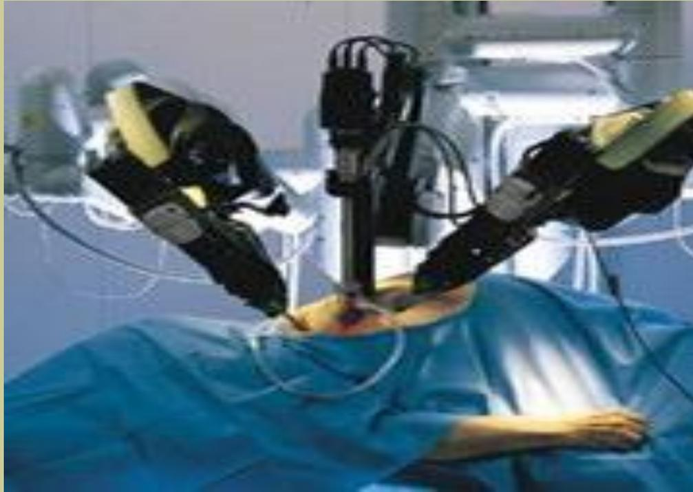
**Эта операционная комната состоит из робота Да Винчи, коммерчески производимого телеманипулятора («операционная медсестра»), устройства замены инструментов, устройство замены деталей, смены материалов, препаратов («санитарка») и операционной Платформы пациента (Жизнеобеспечение при Травме и Транспортировке)**
