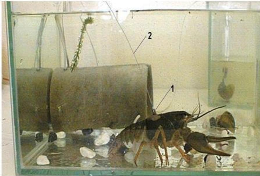
Речной рак с укрепленным на внешней части карапакса волоконно-оптическим датчиком.
