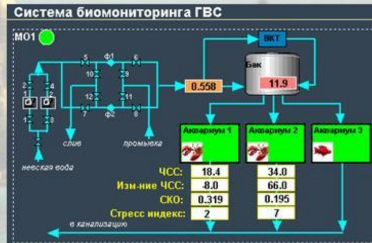
**Применение станции производственного биологического мониторинга качества воды (СПБМКВ) водоисточника, на основе метода вариационной пульсометрии раков и моллюсков на сооружениях водоподготовки ГУП «Водоканал Санкт-Петербурга»**
