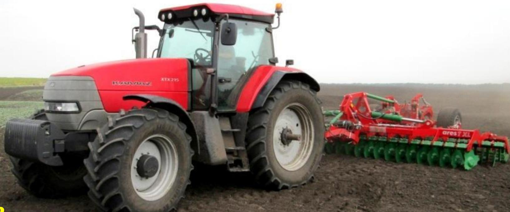
*Затем трактор разрыхляет землю с помощью больших граблей – борона. У них большие острые зубья, которые делают землю мягкой, рыхлой.*
