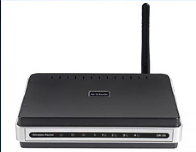
*Router (маршрутизатор) - сетевое устройство, на основании информации о топологии сети и определённых правил принимающее решения о пересылке пакетов сетевого уровня (уровень 3 модели OSI) между различными сегментами сети.*
