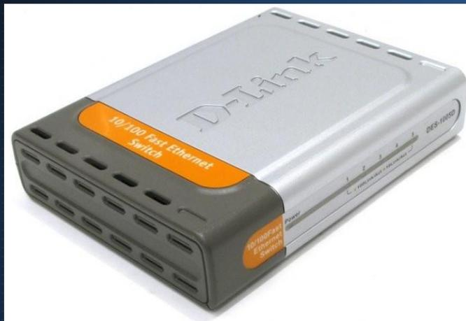
*Switch (коммутатор)* - устройство, предназначенное для соединения нескольких узлов компьютерной сети в пределах одного сегмента. В отличие от *концентратора*, распространяет трафик только к нужному порту.
