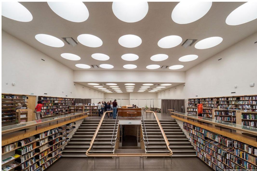
Отдельного комментария заслуживает система освещения читального зала – пятьдесят семь отверстий на плоской крыше наполняют зал рассеянным светом идеальным для чтения.
