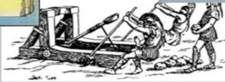
***Рычаг*** - твердое тело, имеющее неподвижную ось вращения, на которое действуют силы, стремящиеся повернуть его вокруг этой оси.
