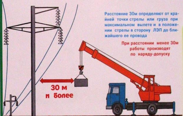
Расстояние 30м определяют от крайней точки стрелы или груза при максимальном вылете и в положении стрелы в сторону ЛЭП до ближайшего ее провода
