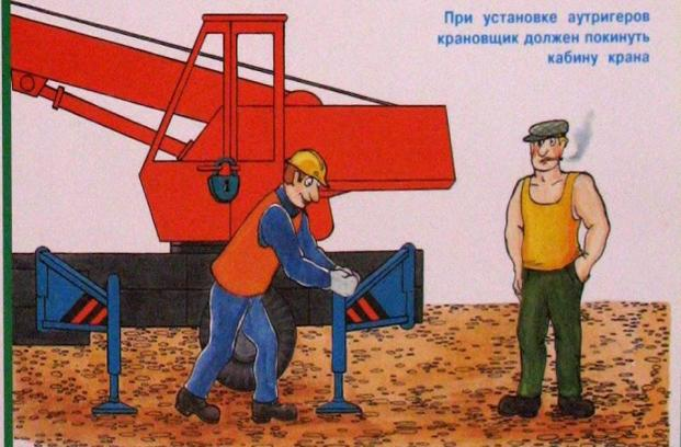
При установке аутригеров крановщик должен покинуть кабину крана
