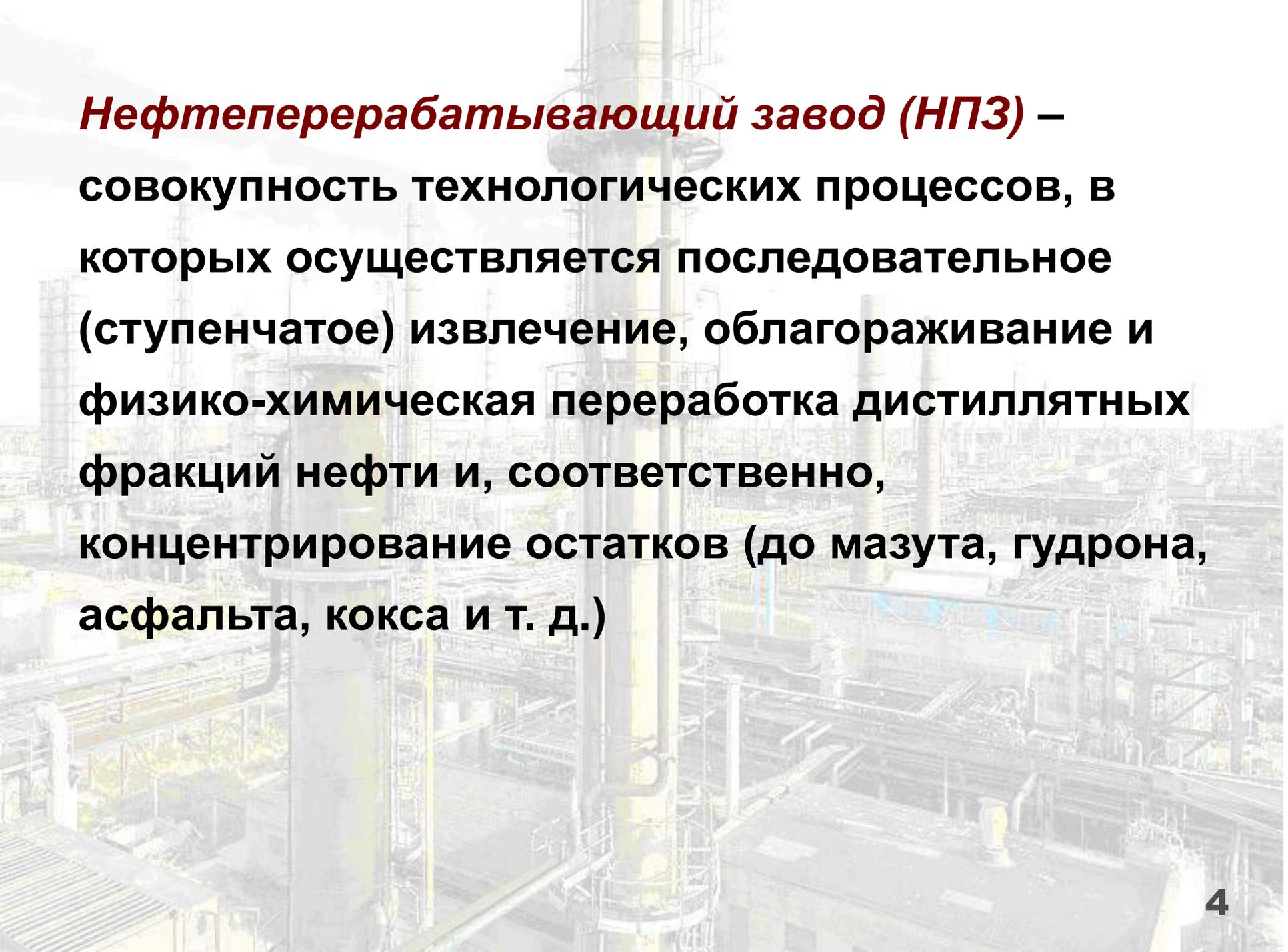
***Нефтеперерабатывающий завод (НПЗ)*** – совокупность технологических процессов, в которых осуществляется последовательное (ступенчатое) извлечение, облагораживание и физико-химическая переработка дистиллятных фракций нефти и, соответственно, концентрирование остатков (до мазута, гудрона, асфальта, кокса и т. д.)
