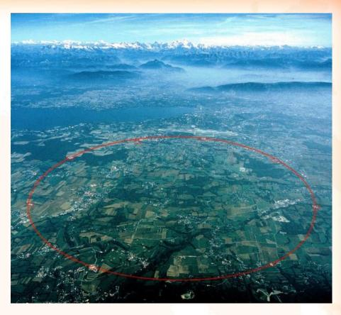
Большим назван из-за своих размеров: длина основного кольца ускорителя составляет 26 659 м; адронным — из-за того, что он ускоряет адроны, то есть частицы, состоящие из кварков.
