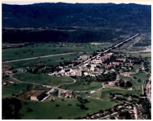
Стэнфордский линейный ускоритель (SLAC.) Он работал в период 1989-1998 гг., имел длину около 3 км и ускорял как электроны, так и позитроны до энергии 50 ГэВ.
